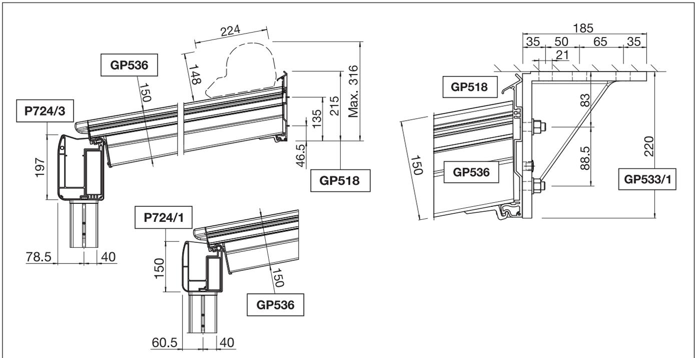
Bei Montage auf Aussenisolation muss das Wandanschlussprofil abgestützt werden (Rohr verstärkt PS311).
